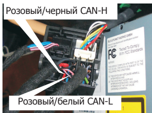
Рис. 1. Расположение контактов шины CAN в разъеме головного устройства
